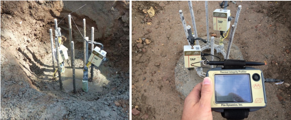
Abbildung 13: Messwerterfassung über TAPs, Auslesung der Messdaten mit TIP
